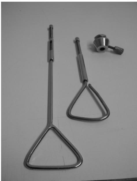
**Figura 6.** Triângulos e peça para prendê-los a tampa.
