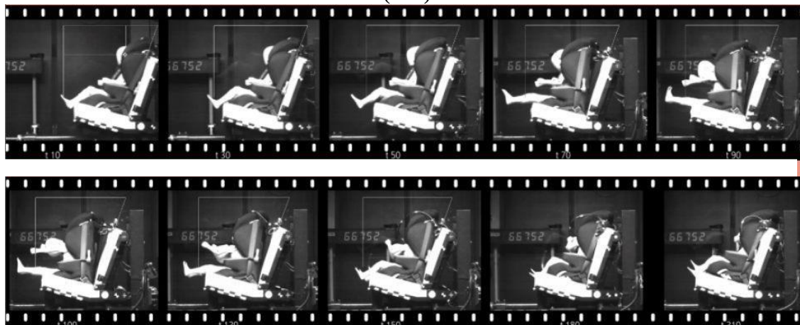
Figura 1- Série de fotografias de uma simulação de impacto frontal feita em uma plataforma de testes (sled)
