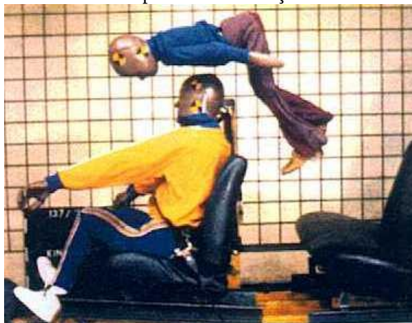
Figura 3- Simulação de uma criança no banco traseiro que não estivesse utilizando qualquer dispositivo de retenção
