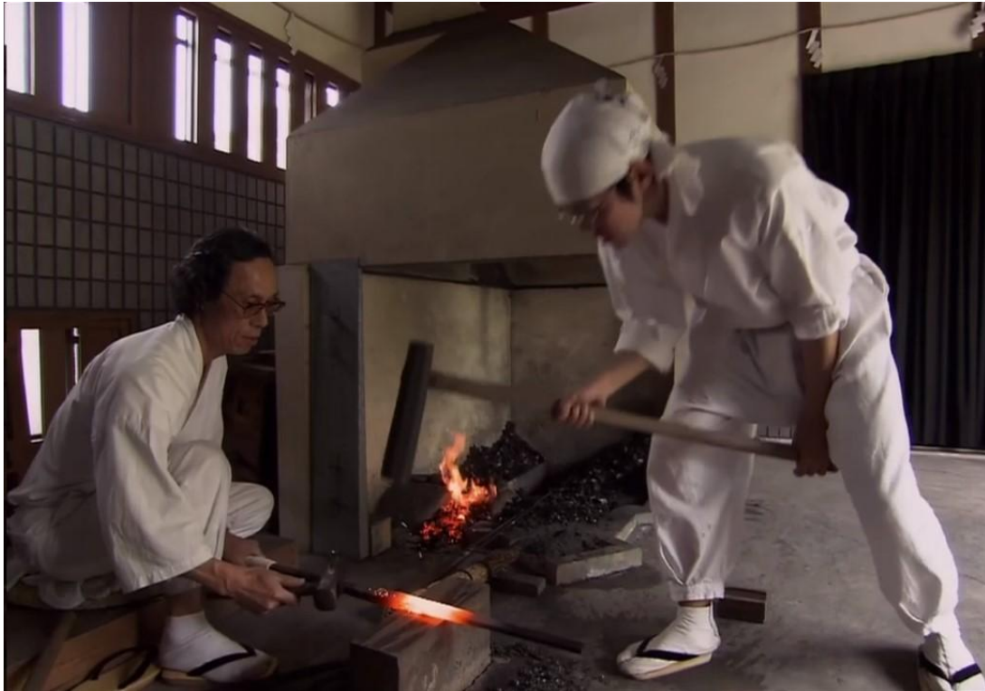
Figura 74: Um trecho do documentário Samurai sword: Making of a legend (Wate, 2007) onde um ferreiro e seu aprendiz forjam uma espada, ainda incandescente pelo calor das chamas, pronta para ter seu metal trabalhado pelo martelo.
