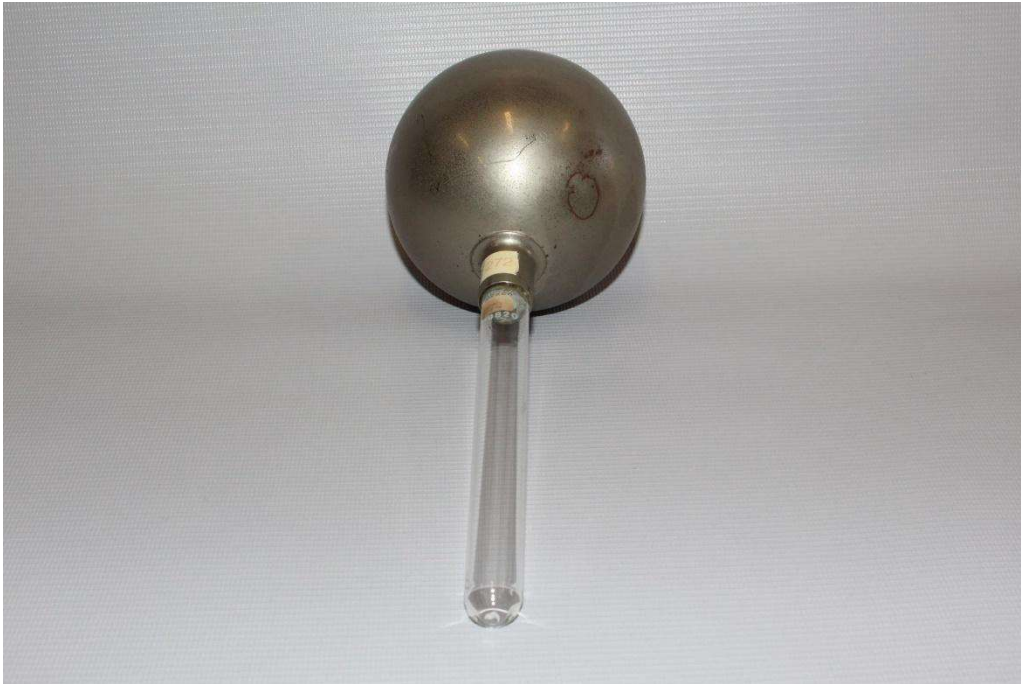
Figura 34 –Esfera oca de Coulomb elaborada no Colégio Marista Arquidiocesano de São Paulo
