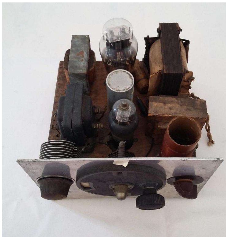
Figura 35 –Amplificador elétrico de audiofrequência elaborado no Colégio Marista Arquidiocesano de São Paulo
