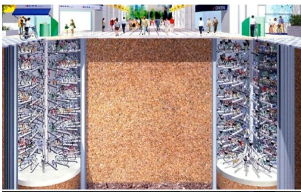
Figura 18. Estacionamento de bicicletas subterrâneo implantado na cidade de Tóquio no Japão. Fonte: < http://www.cidadessustentaveis.org.br/noticias/empresa-japonesa-de-engenharia-cria-estacionamento-subterraneo-para-bicicletas >
